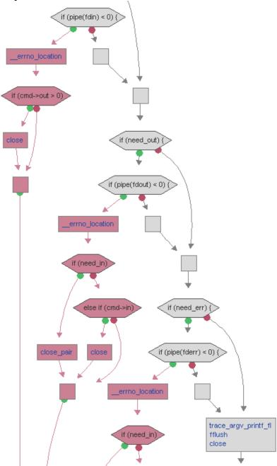
Dans ce schéma, les symboles en forme de losange représentent les décisions. Les blocs de lignes de code sont représentés dans des rectangles. Le code non exécuté est représenté dans les formes et chemins en rouge.
